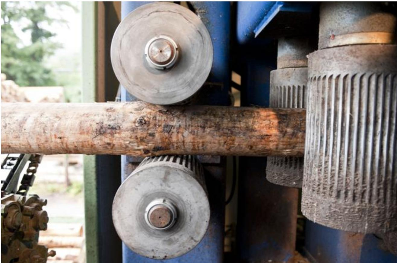
*Fig.: il processo di produzione degli assortimenti quali Uso Fiume ed Uso Trieste prevede l'impiego di frese al fine di garantire il rispetto delle caratteristiche geometriche degli elementi strutturali;*
