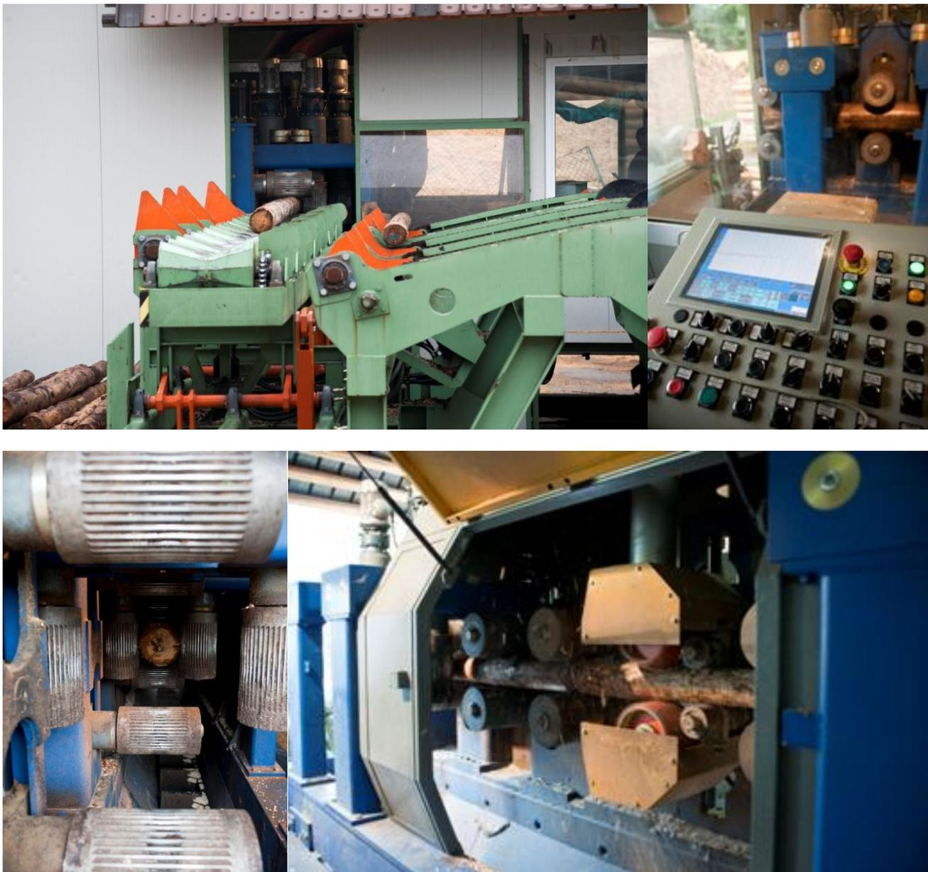
*Fig. La squadratura dei tronchi avviene con macchinari ad alta tecnologia, garantendo la sicurezza durante la lavorazione ed un'alta qualità del prodotto finale; ©Rete Uso Fiume ed Uso Trieste.*
