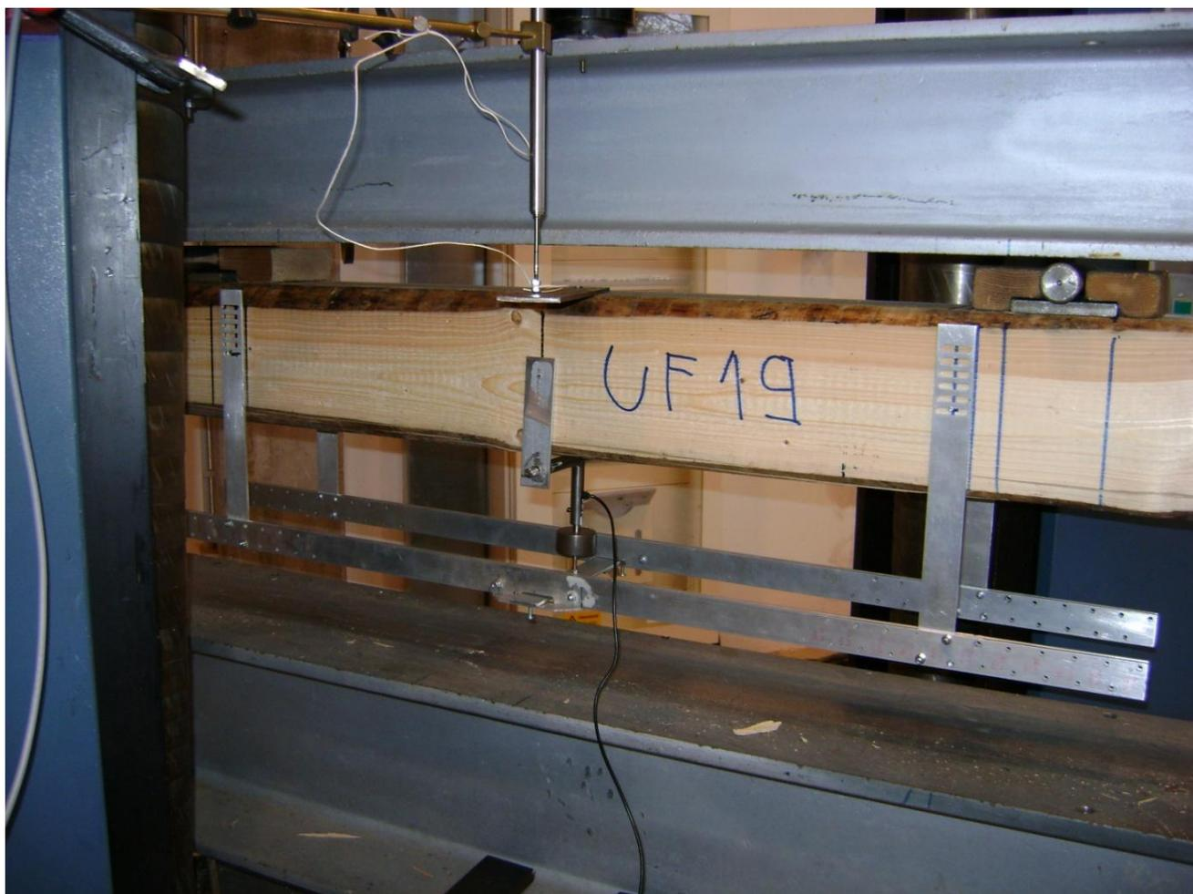
*Fig. Procedimento di misurazione per ottenere il modulo di elasticità locale; lignaconsult- Bolzano (BZ).*
