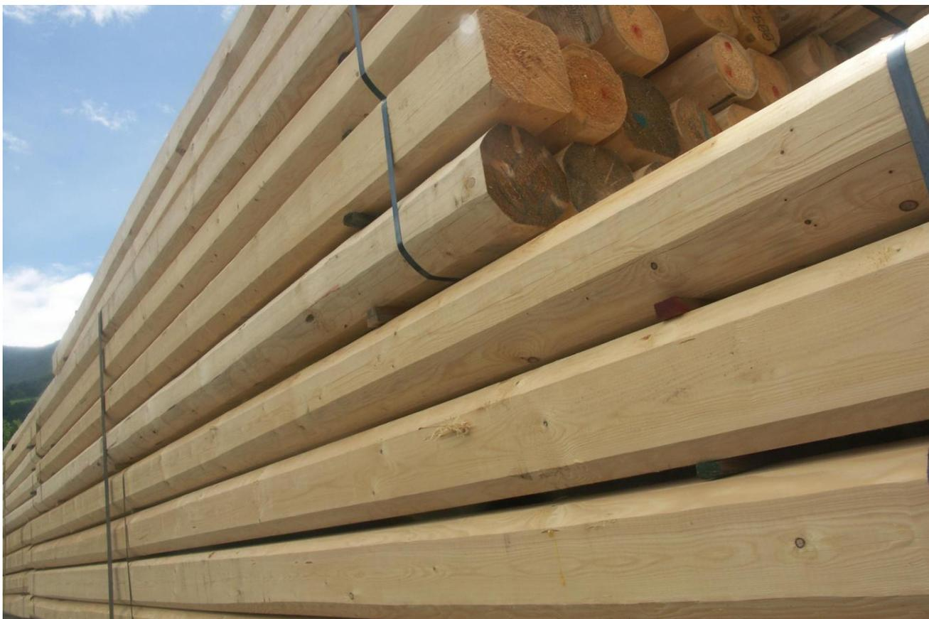
*Fig. Travi "Uso Fiume" ed "Uso Trieste" accatastato; ©Rete Uso Fiume ed Uso Trieste.*
