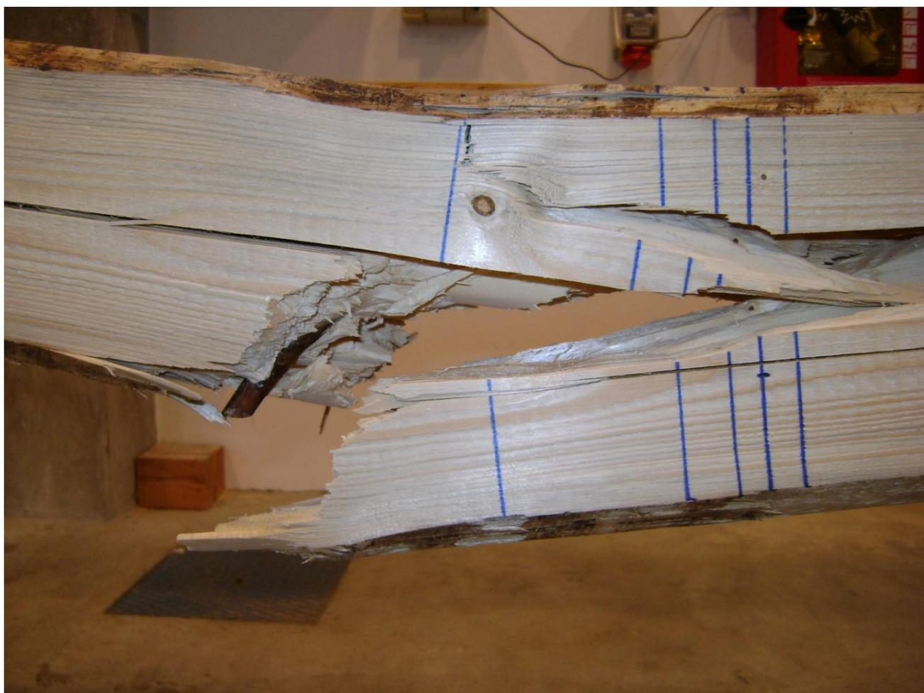
*Fig. Rottura di una trave “Uso Fiume” in corrispondenza di un nodo (nella parte centrale sinistra della foto); lignaconsult- Bolzano (BZ).*
