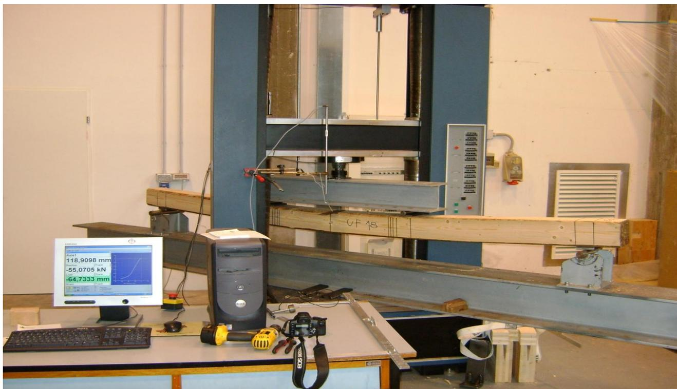
*Fig. Prove di resistenza a flessione sui quattro punti presso il laboratorio di ricerca CNR- IVALSA a S. Michele all’Adige/ TN; lignaconsult- Bolzano (BZ).*
