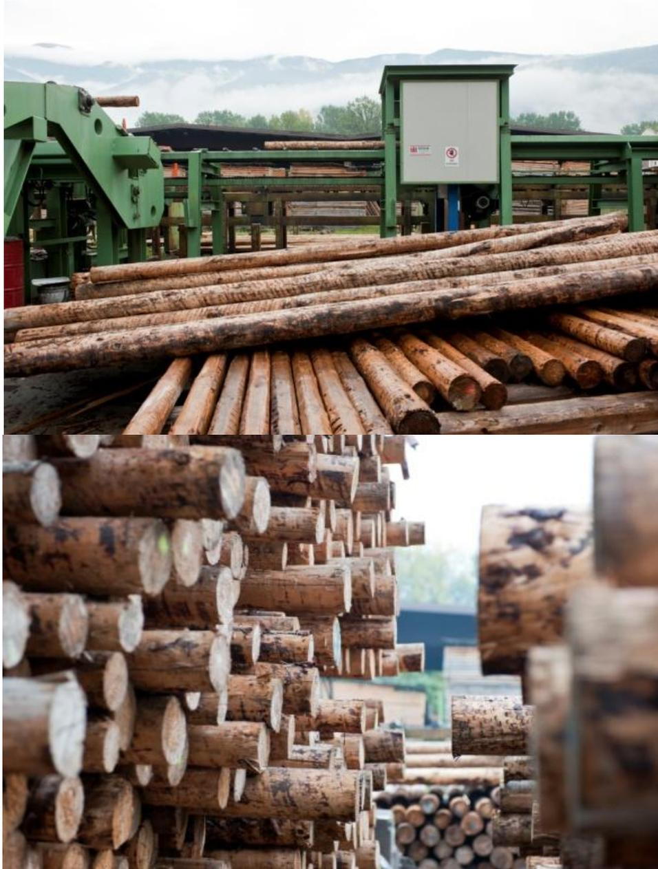
*Fig. Dopo lo stoccaggio il personale specializzato sceglie i tronchi per la lavorazione; in alto la cabina per la misurazione automatica dei tronchi; ©Rete Uso Fiume ed Uso Trieste.*
